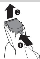
**2** Lắp gờ của bộ phận cắt mới vào rãnh dẫn(1) và ấn bộ phận cắt vào lại thiết bị (2).
