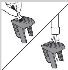
ห้ามใช้แผ่นไข อุปกรณ์ที่มีความคม หรือของเหลวที่มีกรดกรุนแรง เช่น แอลกอฮอล์ น้ำมัน หรืออะซี托น ทำความสะอาดเครื่องเป็นนัยขาด
