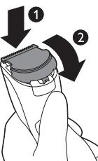
**8** 將刀組的突耳插入導引槽 (1)，接著將刀組推回產品裝上 (2)。
