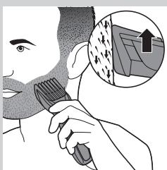
**4** Untuk pemangkasan paling efektif, gerakkan pemangkas berlawanan dengan arah tumbuh rambut. Pastikan permukaan sisir selalu menyentuh kulit sepenuhnya.
