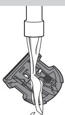
**5** Làm sạch bộ phận cắt bằng bàn chải hoặc rửa dưới vòi nước.
