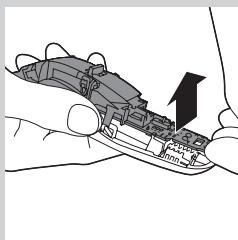
**5** 取下侧面板。从产品中拉出装有充电电池的印刷电路板的下半部分。
