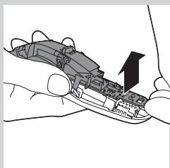
**5** ถอนแผงด้านข้างออก ตึงที่ด้านล่างของแผงวงจรที่มีแบตเตอรี่ที่ชาร์จใหม่ได้ออกจากตัวเครื่อง
