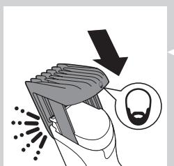
การตั้งค่าความยาวล้ำบนจะแสดงเป็นหน่วยมิลลิเมตร หรือตัดเล็บขนที่ความยาวประมาณ 1 มม. ถึง 23 มม. การตั้งค่าจะแสดงความยาวล้ำที่เหลือหลังจากการตัด
