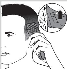
4 ในการกันขนให้มีประสิทธิภาพที่สุด ให้เลื่อนเครื่องไปในทิศทางตรงกันข้ามกับที่เส้นขนออก ตรวจสอบให้แน่ใจ
