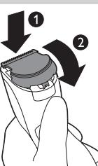
**2** 將新刀組的突耳插入導引槽 (1)，接著將刀組推回產品裝上 (2)。
